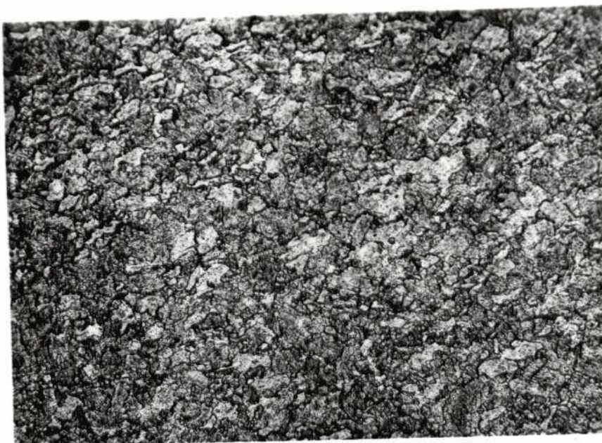
Fig. 3. Dolomía gris oscura, incluida en las margas del Keuper, (muestra 3), x50.
